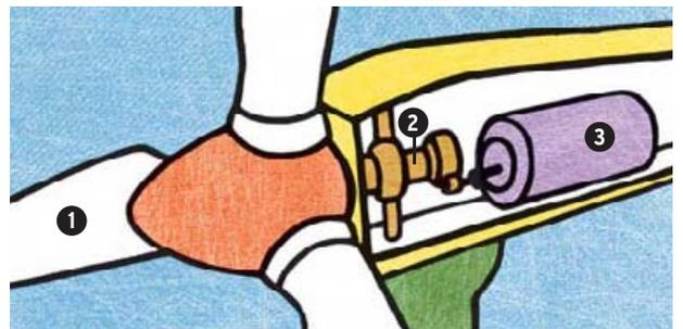
Der Wind setzt die Rotorblätter ① in Bewegung. Die Drehung wird über das Getriebe ② auf den Generator ③ übertragen, der wie ein Fahrraddynamo die Energie der Bewegung in Strom umwandelt.
