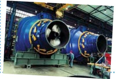
Turbine eines Wasserkraftwerks vor dem Einbau
